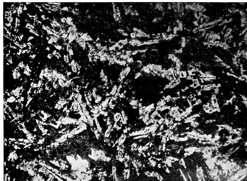
Pórfidos. Trama de cristales de feldespato plagioclase, cuyos intersticios están rellenos por el anfíbol. Luz natural \times 45 .
